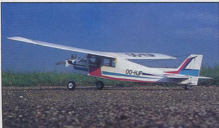
La dérive n'est pas gigantesque. On voit nettement le dièdre faible du Colibri.
