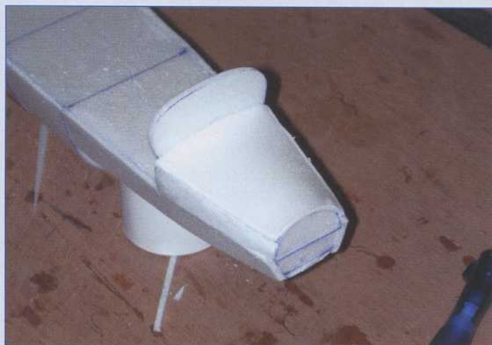
Construction du demi-fuselage inférieur : nez.
