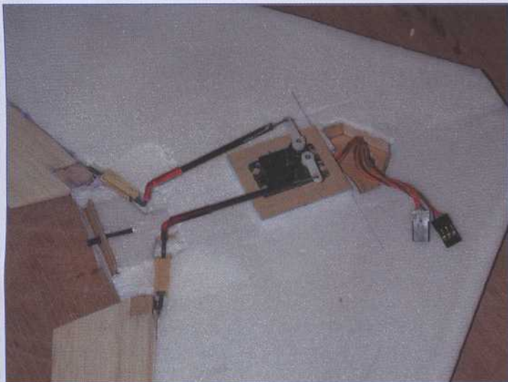
Servos d'ailerons et barres de torsion.
