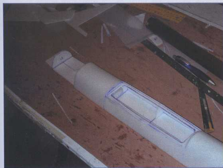
Servos d'ailerons et barres de torsion.
