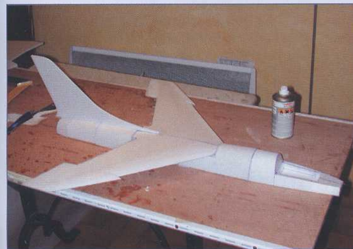
Construction du demi-fuselage supérieur.
