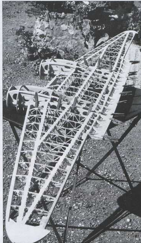
L'aile complète, au séchage. Les bords de fuite sont « sous presse » à l'aide de pinces à linge.
