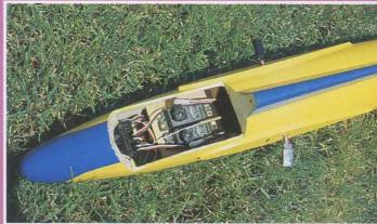
Ci-dessus : les servos de direction et profondeur sont accessibles en retirant le baquet de cockpit. En bas : Les commandes d'ailerons sont en prise directe.
