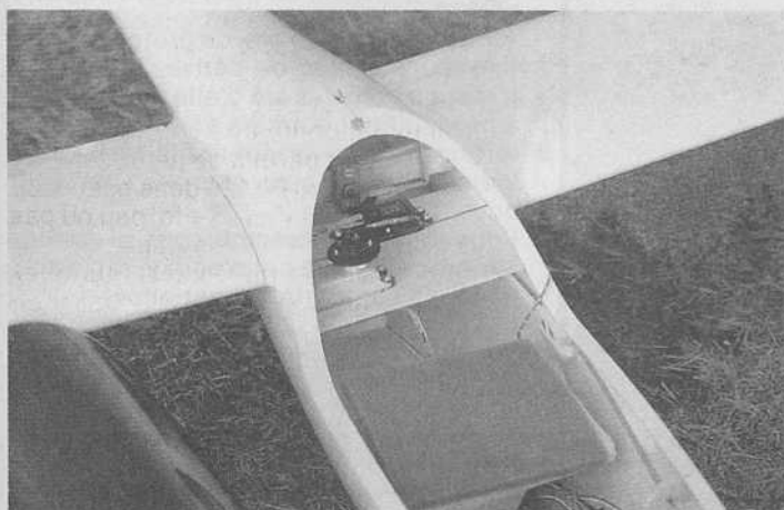
Installation radio avec un seul servo aux ailerons.
