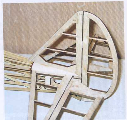
La surface des empennages verticaux et horizontaux, combinée au bras de levier, détermine la stabilité en tangage et en lacet. Leur légèreté a également son importance car elle facilite le centrage du modèle
