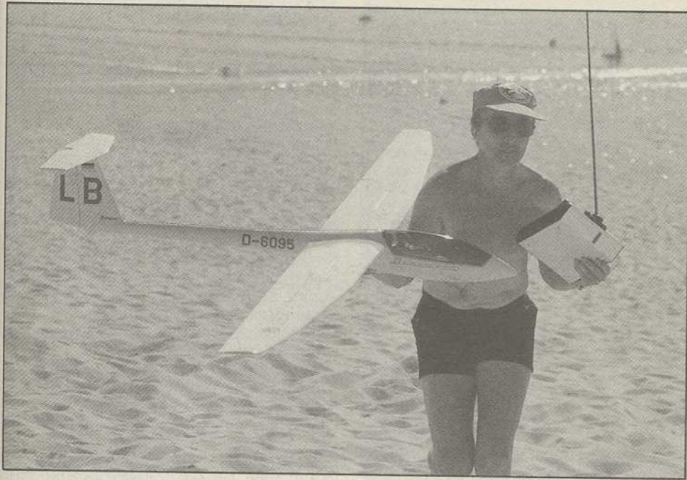
Sur cette photo du modèle de profil, on note très bien la grande profondeur de la dérive et le bord de fuite perpendiculaire au fuselage.
