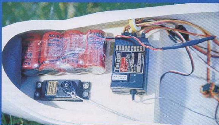
L'installation radio se trouve tout à l'avant. Pratique pour le centrage. On peut remarquer les ferrites au fond du fuselage.
