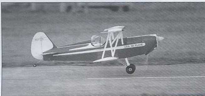
Au décollage, la tenue d'axe est facile grâce à la grande dérive compensée.
