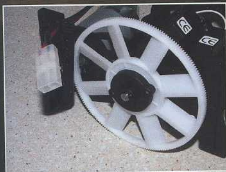
La couronne principale est également une turbine de ventilation très efficace.
