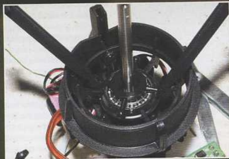
Le plateau cyclique ne possède pas de rotule centrale, le guidage se fait par des patins extérieurs !
