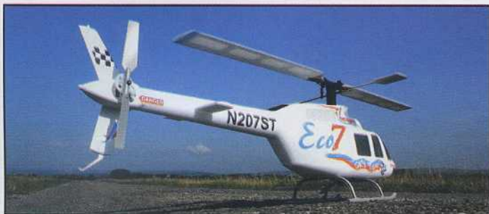
Le train dégage bine le rotor anticouple, et une béquille le protège. Pratique pour poser dans l'herbe.
