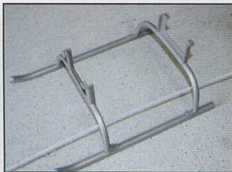
Le train clipsé assure le verrouillage du bloc mécanique !
