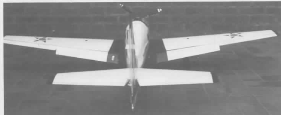
Vue arrière permettant d'apprécier la surface des volets en position sortie.
