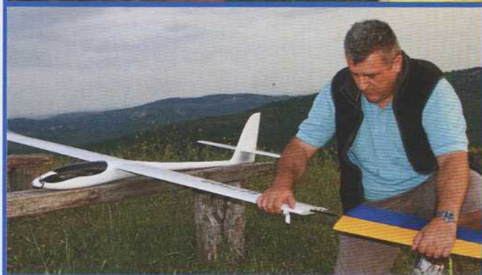
Pas de prises entre les panneaux d'aile : pas de risque de déconnexion...et il suffit de replier les tronçons pour le transport.
