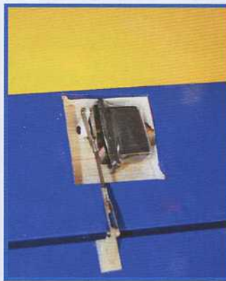
Le servo d'aileron dans sa gangue plastique, permettant son extraction à postériori.
