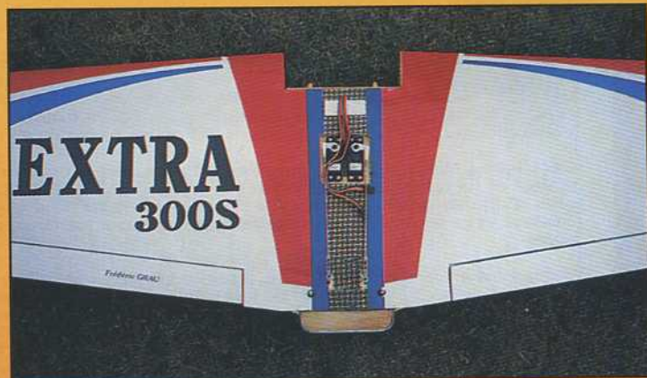
L'auteur a installé deux servos pour les ailerons, ce qui permet d'affiner facilement les réglages.
