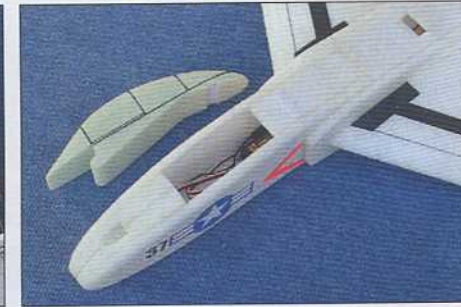
Encoche à l'avant et velcro à l'arrière pour la verrière.
