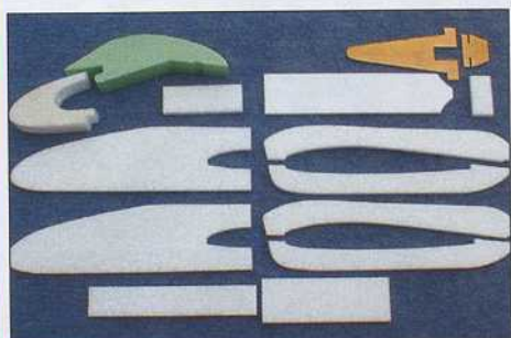
Constituer d'abord le «kit» du fuselage. A partir d'EPP de 10 mm.
