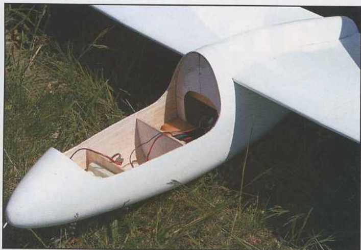
Cabine ouverte, la structure monocoque du fuselage est bien visible.
