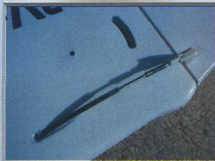
La commande de direction par câble tressé et chape réglable.
