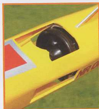
Gros plans sur le montage de la turbine Xfan 56.
