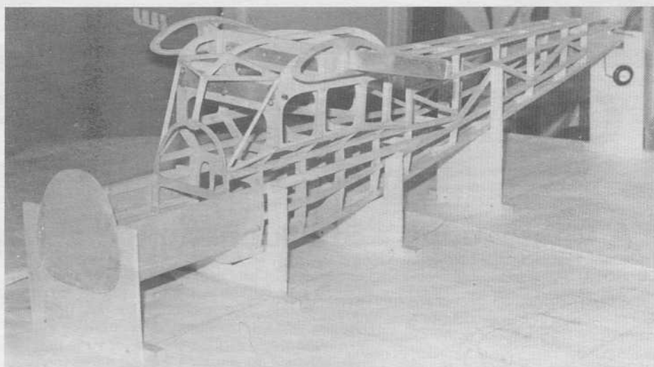
Les gabarits de montage sur chantier avec la structure du fuselage au terme de sa construction.
