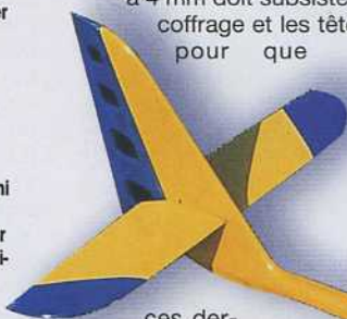
Le volet de dérive étant fourni dans un balsa suffisamment dense, il a pu être évidé pour l'alléger sans perdre en rigidité. Les demi-stabs ont subi eux aussi une cure d'allègement, à la fraise à bois rotative.
