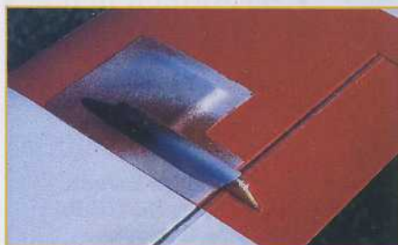
Un mini-servo attaque chaque aileron, en dépassant légèrement de l'intrados. C'est pourquoi des caches sont fournis, qui carènt du même coup la tringlerie de commande. Les guignols en fibre sont à coller en place.
