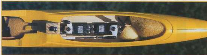
La réception loge tranquillement à l'avant du fuselage. Malgré tout, il a fallu ajouter un peu de plomb pour obtenir le centrage, le poids final du planeur étant toutefois conforme à celui annoncé.
