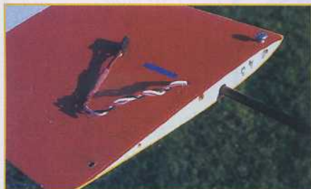
Les ailes bénéficient d'un système de fixation original à l'avant : les têtes de deux vis vissées à l'intrados viennent se glisser dans deux fentes découpées dans l'assise. On voit aussi le lest de 200 g vissé au fond du fuselage, qui améliore sensiblement le comportement du Fitness en vol.
