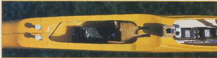
Les ailes bénéficient d'un système de fixation original à l'avant : les têtes de deux vis vissées à l'intrados viennent se glisser dans deux fentes découpées dans l'assise. On voit aussi le lest de 200 g vissé au fond du fuselage, qui améliore sensiblement le comportement du Fitness en vol.
