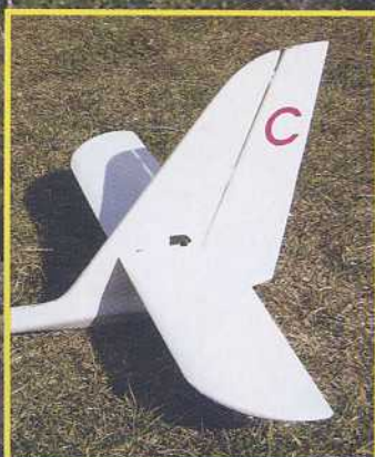
Le stabilisateur cruciforme est doté d'un empennage pendulaire particulièrement efficace !
