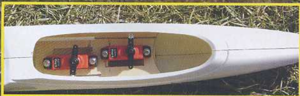
Ci-dessous : les micros servos de profondeur et direction s'installent sans "chasse-pied". L'assise de l'aile (et donc le fuselage à cet endroit) semble très solide.
