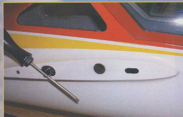
Le karman du fuselage intègre le fourreau du tétou d'incidence, le trou du ressort de maintien, celui du fourreau de clé principale, et le trou du fil de servo.
