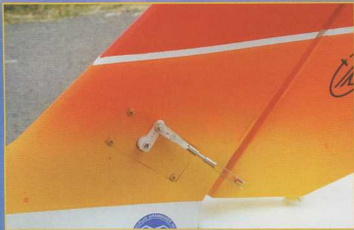
Une trappe recouvre le servo de direction, logé dans la partie fixe de dérive.
