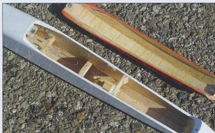
La grande bulle est simplement maintenue par un téton en plastique à l'avant et un aimant à l'arrière.
