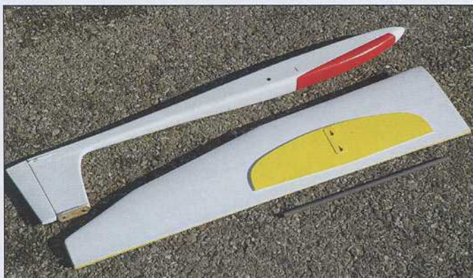
Le Fractale est entièrement démontable sans outil et en quelques secondes. Avec son aile en 2 parties et son fuselage de 80 cm de long, il est vraiment très facile à transporter...
