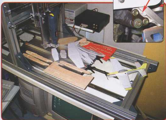
Exemples d'utilisations : en haut, fraisage d'un support de silencieux en carbone et sur la table, gravure, découpes, décorations...
