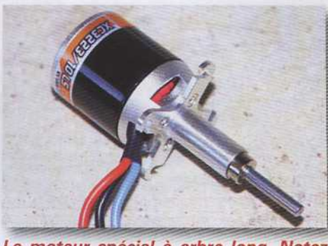
Le moteur spécial à arbre long. Notez le porte roulement supplémentaire qui guide parfaitement l'arbre.
