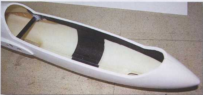
Notez les renforts carbone dans l'avant du fuselage, et les nervures ctp intégrées au moulage dans les emplantures.
