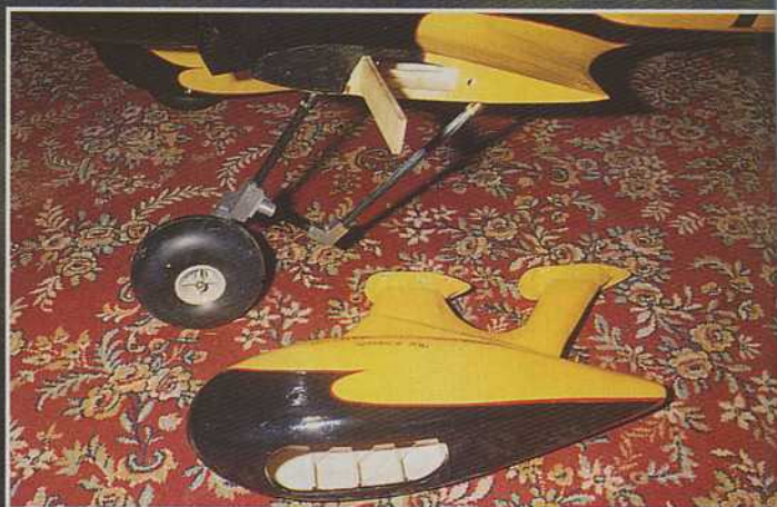
Ci-dessus : Les trains sont démontables grâce à plusieurs pièces usinées en alu. Leurs carénages sont réalisés, sur le proto, en lattes de balsa, comme le fuselage !
