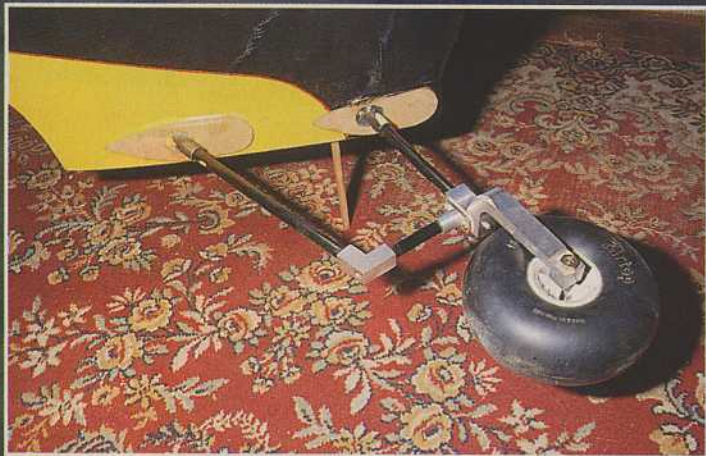
Ci-dessus : Les trains sont démontables grâce à plusieurs pièces usinées en alu. Leurs carénages sont réalisés, sur le proto, en lattes de balsa, comme le fuselage !
