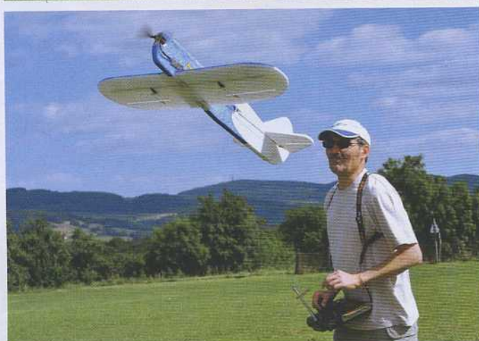
Avec moins de 1 mètre d'envergure et des ailes démontables, ce petit Gee Bee sera facile à transporter
