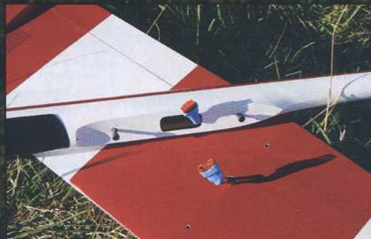
La connection des servos d'aile est réalisée avec une prise MG6.
