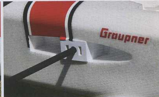
Sur le fuselage, des inserts en plastique servent de solides guides pour la clé d'ailes.
