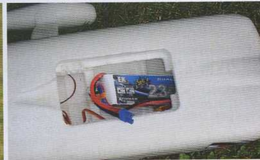
Une trappe supérieure constitue l'unique accès à l'intérieur. On y installera le récepteur et l'accu LiPo 4S de 2200 mAh environ (ici un Dualsky 2300 mAh 35 C).
