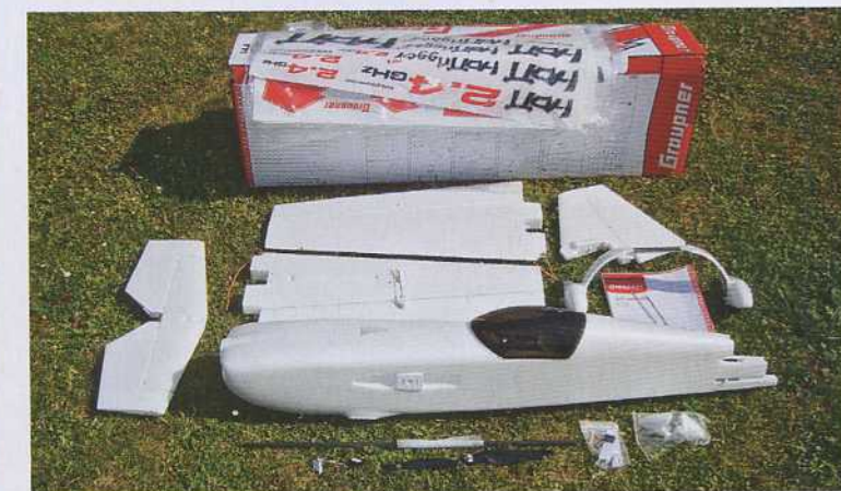
Le stabilisateur et la dérive sont installés par vissage et sont facilement démontables.
