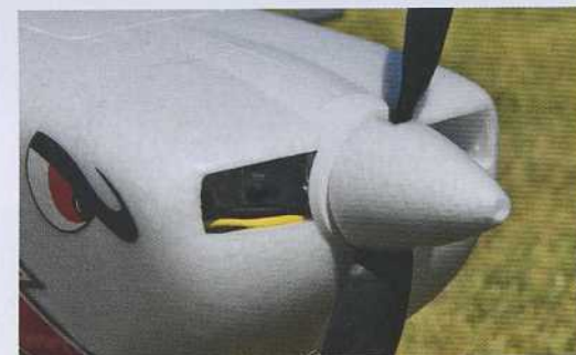
Il n'y a pas de trappe pour accéder au moteur, qui est installé par l'avant sur une plaque en alu.
