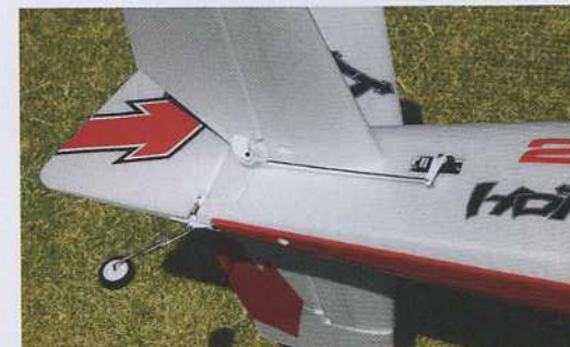
Le stabilisateur et la dérive sont installés par vissage et sont facilement démontables.
