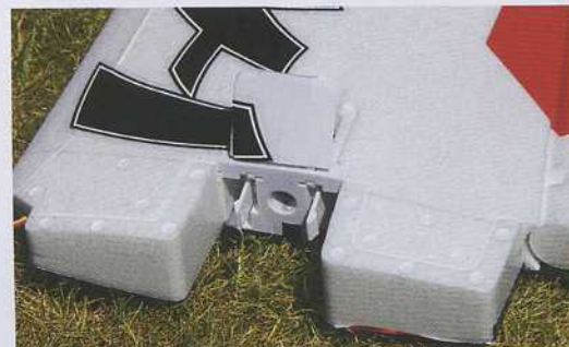
Très astucieux, le système de verrouillage des ailes se fait avec ce clip.
