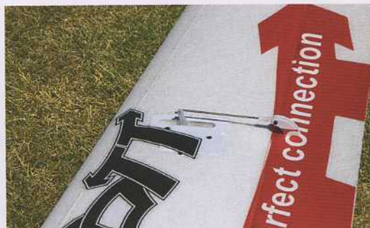
Astucieux, les supports de servos d'ailerons font également office de guide pour la clé d'ailes en carbone. Idéalement, les servos auraient pu être plus rapides.
