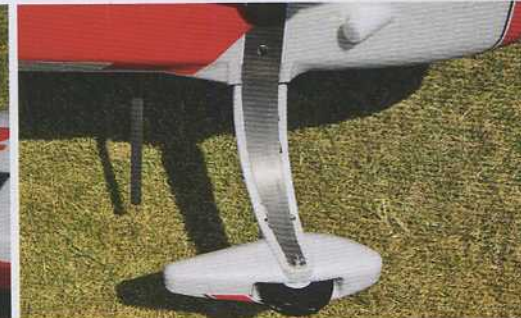
Le train en aluminium est solide et est habillé de mousse Solidpor.
