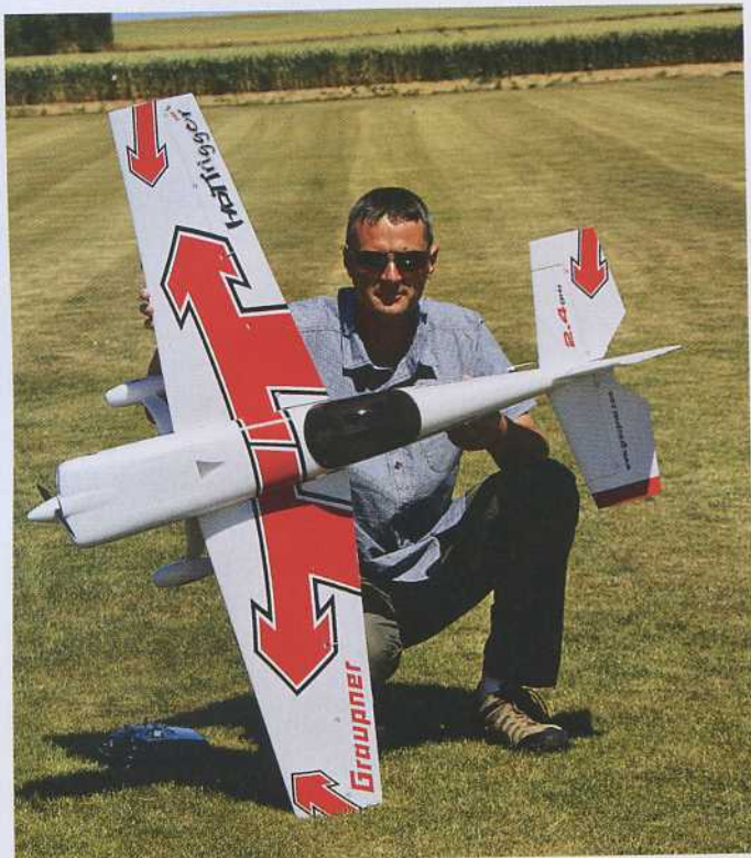
Le modèle est relativement volumineux mais il sera très facile à transporter grâce à ses ailes en deux parties, son stabilisateur et sa dérive démontables.
