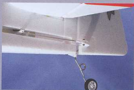
Les chapes à rotule, emprisonnées dans les guignols doubles donnent un mouvement précis et sûr.
