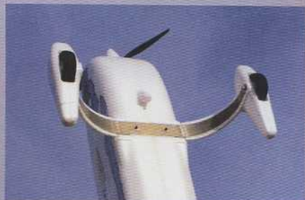
Le train, fait en duralumin, et habillé de Solidpor, est livré prêt à poser. Il est fixé par deux vis BTR de 3 mm.
