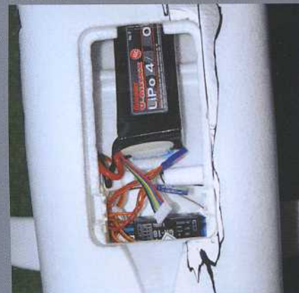
Pour respecter le centrage préconisé, il faut placer l'accu à l'arrière dans son emplacement. Il y a suffisamment de place à l'avant afin que les pilotes moins expérimentés puissent l'avancer.
