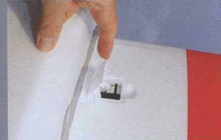
Système très ingénieux de verrouillage des ailes par deux crochets qui viennent se verrouiller dans l'emplanture du fuselage et que l'on manœuvre au moyen d'une petite trappe en plastique.
