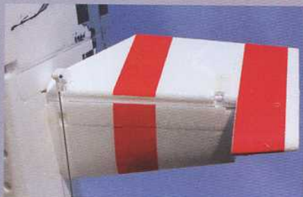
Les charnières en plastique sont intégrées dans les gouvernes. Elles offrent une excellente liberté de mouvement et un débattement très important.
