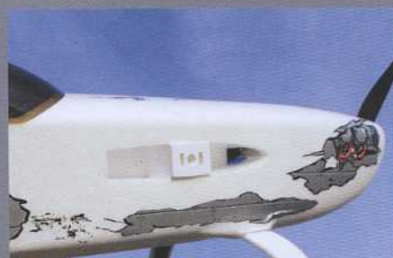
Pour respecter le centrage préconisé, il faut placer l'accu à l'arrière dans son emplacement. Il y a suffisamment de place à l'avant afin que les pilotes moins expérimentés puissent l'avancer.
