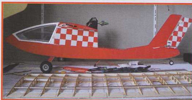
Les ailes en cours de construction devant le fuselage, déjà fini !
