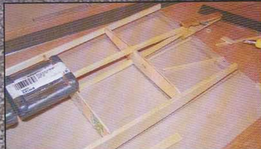
Le stab : rectangulaire, il s'amincit simplement en pinçant les longerons après la dernière nervure.
