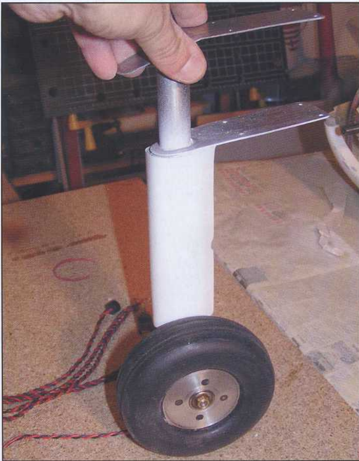
Le train est conçu exactement comme sur l'original et vient entourer le longeron.
