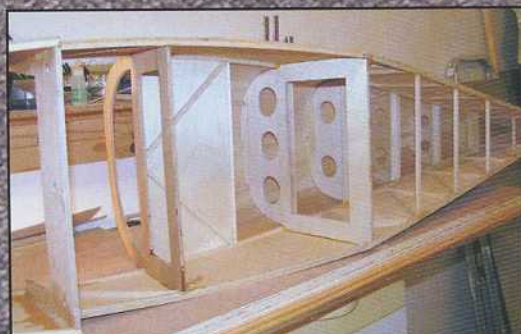
La totalité des couples en place, le fuselage est rigide et léger.
