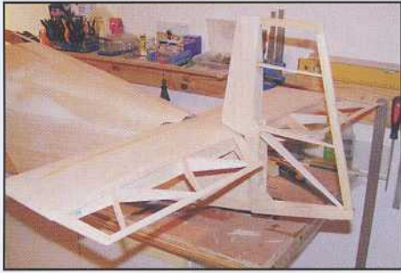
La structure des empennages terminée.
