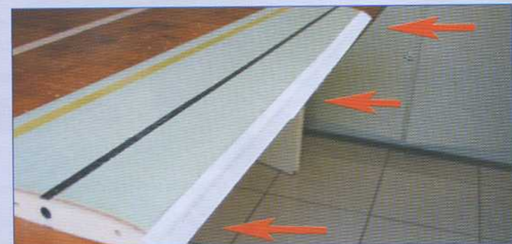
Pose du bord d'attaque, double face + époxy rapide. Tissu 160 g (Kevlar) ou 200 g (verre) avec du scotch double face transparent pour photo. De l'époxy rapide est appliquée sur le bord du tissu pour éviter que la résine ne décolle tout avant la mise sous vide.
