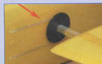
La poulie en carbone est entraînée par un câble doublé par sécurité.
