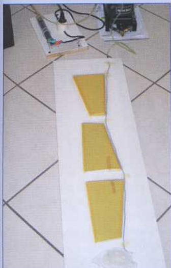
Mise sous vide de la dérive et du stabilisateur.
