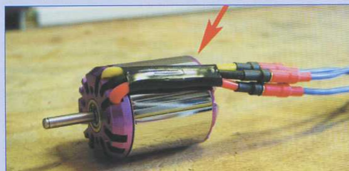
Une gaine thermo empêche les fils de toucher la cage tournante.
