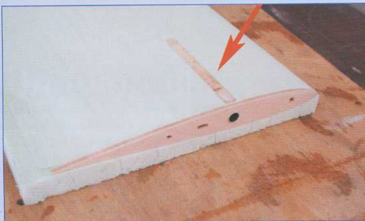
Mise en place de la dé d'aile en tube alu. La nervure d'emplanture contre-plaqué aviation de 50/10 est collée, le saumon est en ctp de bouleau 30/10.
