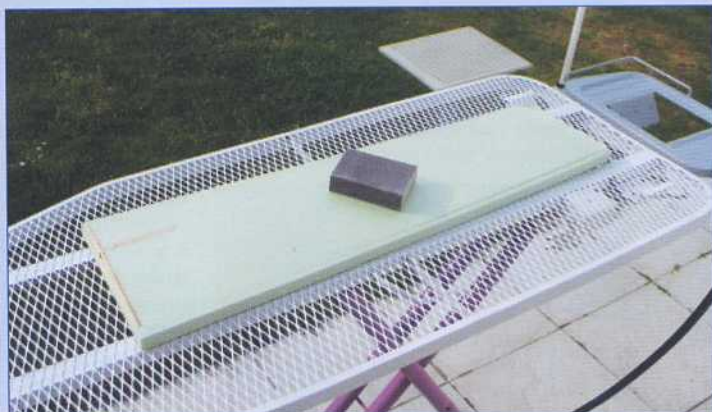
Ponçage avec une cale à poncer.
