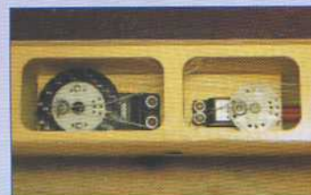
Le servo de profondeur et sa grosse poulie à côté de celui de dérive.
