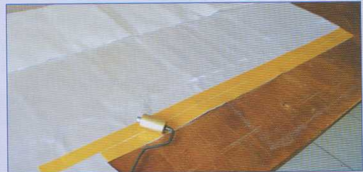
Préparation du bord d'attaque en tissu 200 g et double face.
