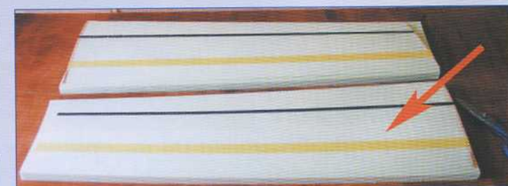
Préparation des charnières en Kevlar (dans le cas d'un coffrage en tissu de verre). Les dépouilles d'intrados sont ensuite immobilisées sur un panneau de mélaminé de 40x180 cm avec du scotch double face. Un tube (ou une cordelette) sert de drain pour faciliter la mise au vide. Le Polyane d'intrados est immobilisé aussi avec un morceau de double face au niveau du bord d'attaque sur toute l'envergure (ainsi, il n'y a pas de risque de glissement).
