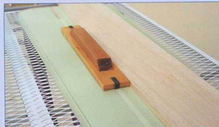
Ponçage avant pose des longerons en carbone UD. Le logement des longerons est fraisé avec une cale à poncer contre une planche en balsa 80/10 pour ne pas marquer l'aile.
