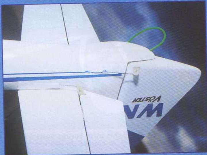
Les sorties de commande, et l'étambot qui protège bien le volet de dérive.
