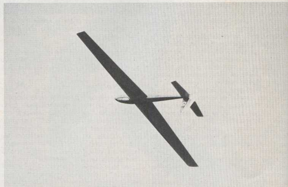
Le profil Eppler 374 permet un vol dos sûr et très stable sans beaucoup de correction à la profondeur. Mais ne centrez pas trop en avant !
