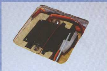
Les servos de l'aile sont montés à plat, ils sont immobilisés dans des supports en bois taillés à la dimension exacte puis bloqués par une languette vissée. Pour les commandes des volets, l'auteur a utilisé une chape de verrouillage en plastique afin de faciliter le montage (et l'éventuel démontage).
