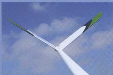
L'empennage, ouvert à 110°, a une parfaite efficacité.
