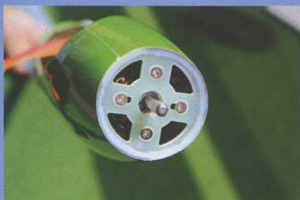
Le moteur installé dans la version PNP est le GTX 3546. Il est vissé sur un couple en époxy.
