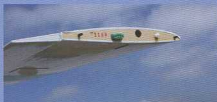
Les servos de l'aile sont montés à plat, ils sont immobilisés dans des supports en bois taillés à la dimension exacte puis bloqués par une languette vissée. Pour les commandes des volets, l'auteur a utilisé une chape de verrouillage en plastique afin de faciliter le montage (et l'éventuel démontage).
