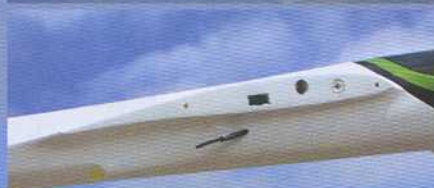
Sur la nervure d'emplanture et le fuselage, on trouve l'emplacement de la clef d'aile, les pions d'incidence en carbone, le téton de verrouillage (Multilock de Multiplex) et la prise Multiplex. Ils sont déjà installés dans la version PNP.
