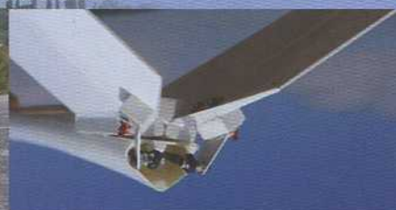
Les guignols des gouvernes du stabilisateur sont en aluminium. L'auteur a rehaussé les guignols afin de favoriser le mouvement des commandes.
