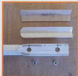
Les pièces de la modification de l'assise du stabilisateur.
