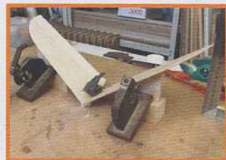
Le stab a été modifié pour avoir une classique ouverture à 110°.
