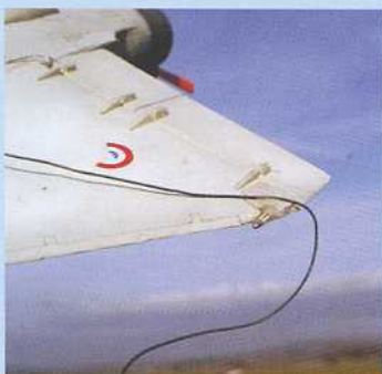
Pour éviter que l'antenne se prenne dans l'hélice, celle-ci est fixée en bout d'aile avec un bout de scotch.
