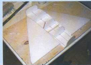
Le coffrage de l'extrados de l'aile, à réaliser sur un chantier exempt de vrillage.
