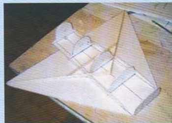
Montage de l'ossature primaire.
