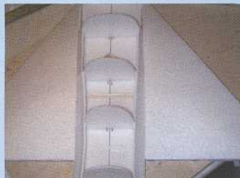
Ci-dessus et en haut, le travail le plus délicat à réaliser : le raccord aile/fuselage.
