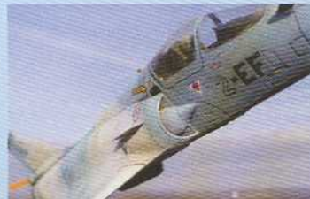
Détail d'une prise d'air équipée de sa «souris».
