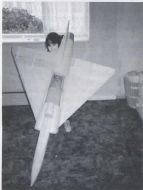
Le Mirage 2000B, recto-verso. Dessous, on voit les trappes des servos d'élévons. Dessus, la trappe d'accès au moteur. L'appareil est prêt à recevoir son recouvrement.
