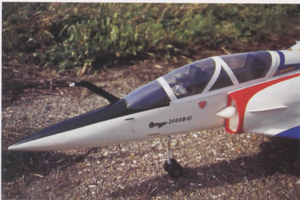
L'avant du 2000B avec son installation de ravitaillement en vol. ▲ ▼ Le premier prototype, Mirage 2B.
