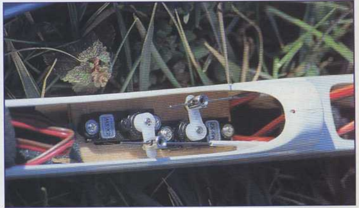
Deux micro servos se logent dans le nez du Mistral.
