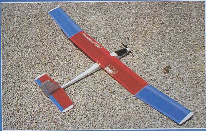
Les ailes en structure sont mises en valeur par l'entoilage translucide.
