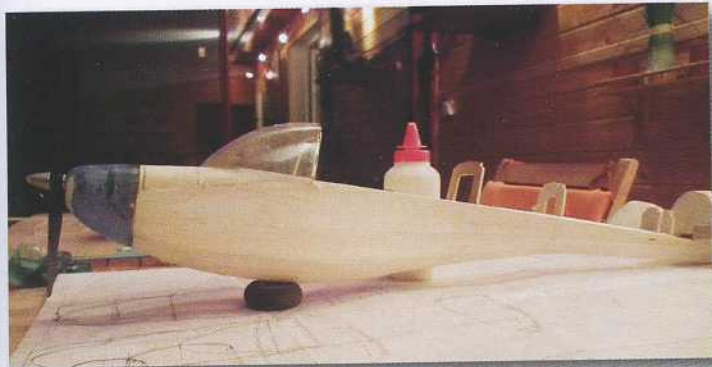
Le dessous du fuselage a été coffré. Notez le capot moulé dans une bouteille de soda.
