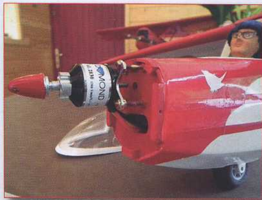
L'avant du fuselage sans, puis avec capot. Notez les tiges filetées permettant un réglage aisé des angles du moteur.
