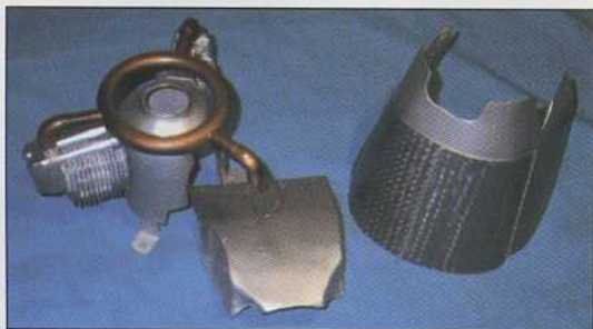
Les trois éléments qui constituent le capot. On aperçoit la cap en forme qui ceinture le cylindre afin de maintenir solidement le collecteur d'échappement.
