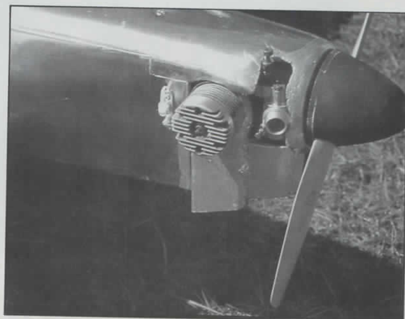
Le moteur monté à l'horizontal avec son échappement extérieur mais toutefois discret.
