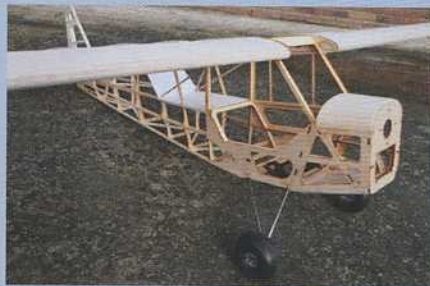
Le fuselage est constitué de deux flancs, en contreplaqué ajouré sur l'avant, et en treillis de baguettes à l'arrière.
