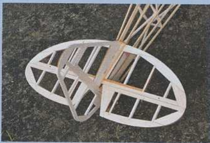
Les empennages sont de type planche, en balsa. Les volets de profondeur seront raccordés par une tringlerie en Y.
