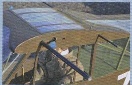
Les clés d'ailes sont en joncs de carbone, le haubanage ajoutera de la solidité à l'ensemble.
