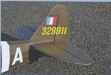
Les empennages sont haubanés par du fil de pêche acier.
