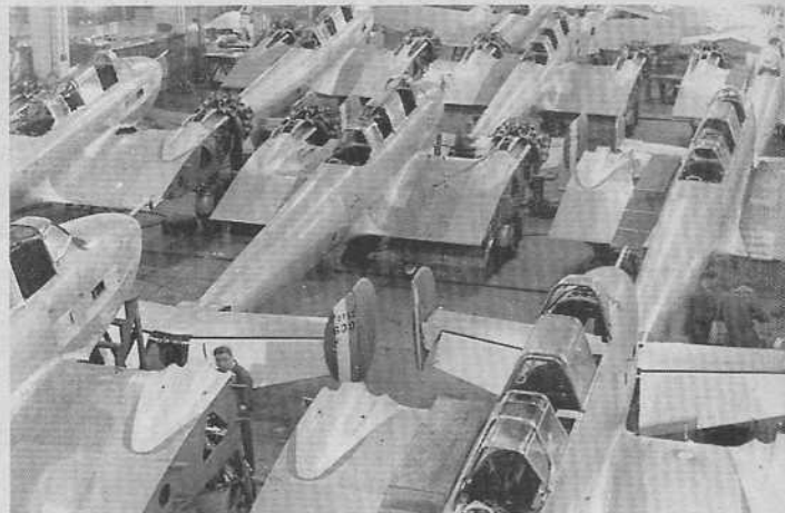
Montage des tronçons centraux d'aile sur les fuselage de Potez 630 (Musée de l'Air).
