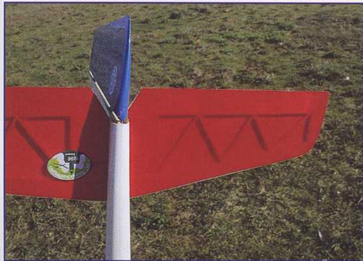
La structure hyper légère des empennages, mise en évidence par l'entoilage transparent.
