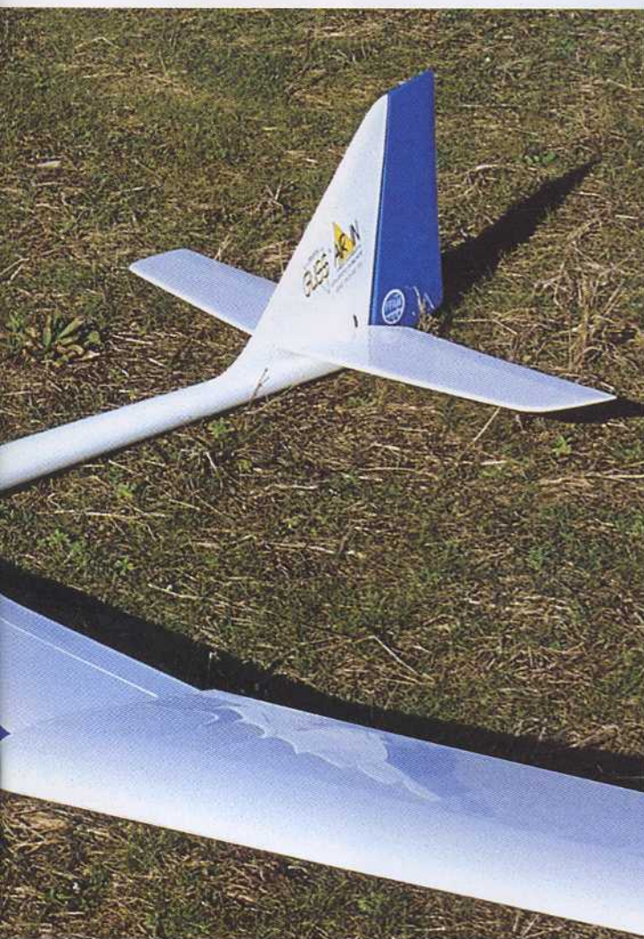
La structure hyper légère des empennages, mise en évidence par l'entoilage transparent.
