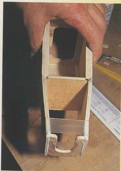
14) Coller F1 et F2 en vérifiant la symétrie du fuselage.
