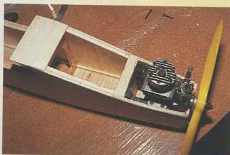
17) Vous pourrez ensuite coffrer dessus et dessous de fuselage.
