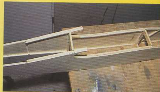
13) Assembler l'autre flanc sur ces couples.
