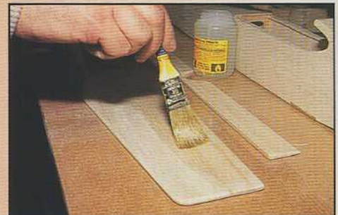
7) Passer deux couches d'enduit nitro poncées à sec au papier n° 600 et vous obtenez un poli parfait.
