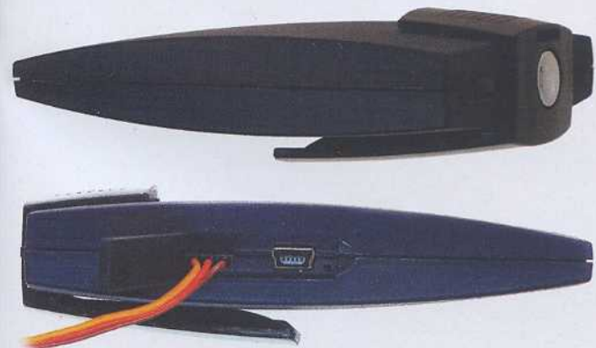
Les flancs de l'appareil, avec la prise mini-USB de charge et l'interface USB 85479, spécifique et optionnelle, ici reliée.
