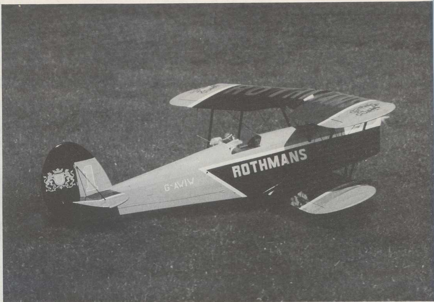
Le Stampe au point fixe avant décollage : toujours bien se mettre dans le lit du vent (de face), sinon gare au saumon qui touche !
