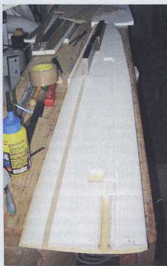
Les gabarits de découpe des noyaux des ailes.
