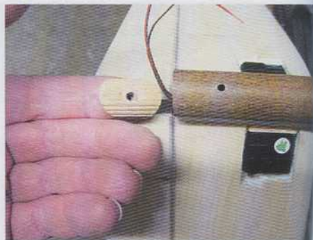
Mise en place du bloc qui va recevoir vis immobilisant le stab sur la poutre
