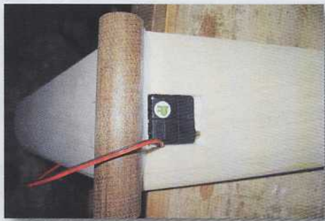
Les servos des stabs sont intégrés dans les plans fixes. Notez la portion de tube solidaire des empennages.
