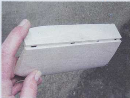
Les charnières des stabs sont décalées côté extrados.
