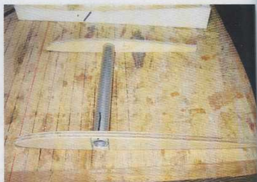
Le fourreau de clé d'aile et les nervures en ctp.
