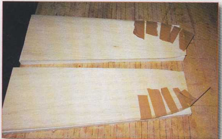
Les stabs à extrémités arrondies demandent à «gratter» localement le polystyrène avant de resserrer les coffrages.
